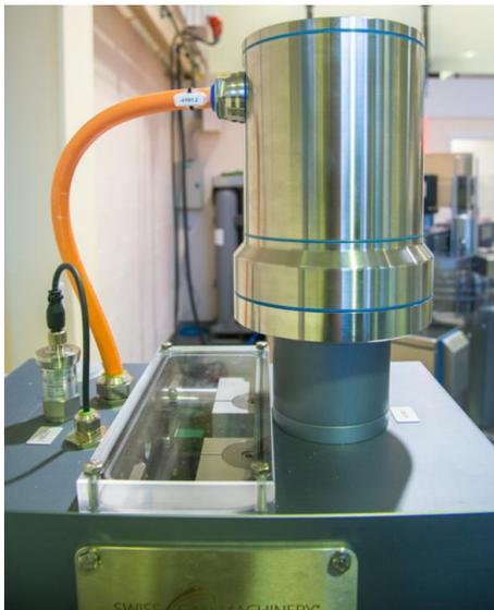
*Per impianti destinati al settore farmaceutico o alimentare, Swiss Can Machinery utilizza i servomotori in acciaio inossidabile AKMH di KOLLMORGEN.*
